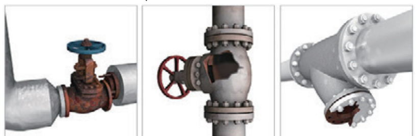
ウォーターハンマーによる配管などの破壊例
